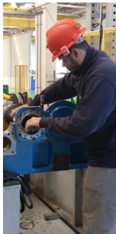
A **Sumitomo Drive Technologies** realiza uma minuciosa análise dos componentes do Redutor. **Nesta análise**, como diferencial, incluímos a análise de partículas magnéticas nas engrenagens e eixos, a verificação dos perfis dos dentes do engrenamento e a medição da carcaça em equipamento tridimensional de última geração. Com o **padrão japonês** de tecnologia e qualidade, oferecemos a maior garantia do mercado.
